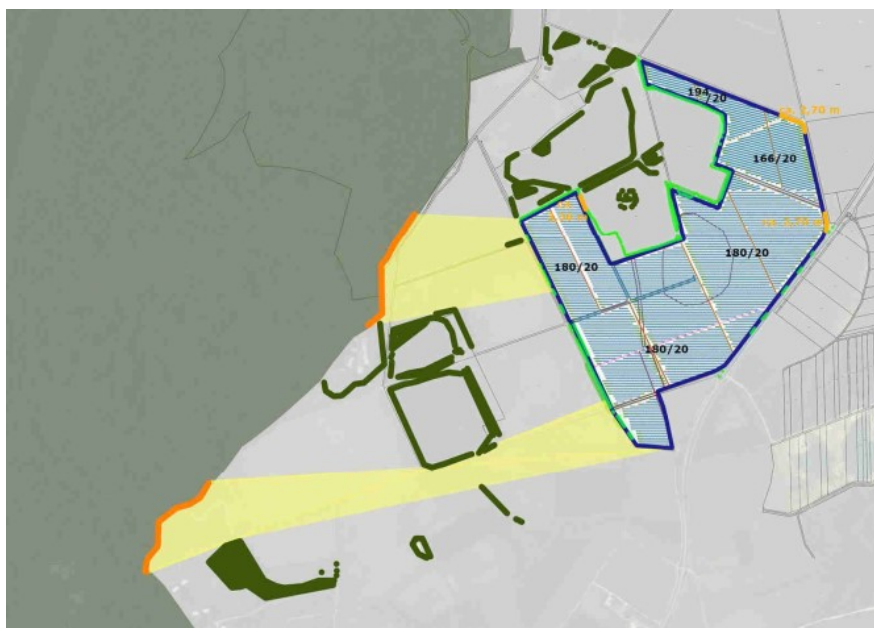
Abb. 5: Mögliche Sichtverbindungen und Reflexionen (orange) von PV-Modulen zum Waldrand, gutachterliche Stellungnahme, IBT 4LigH GmbH, o.M.
