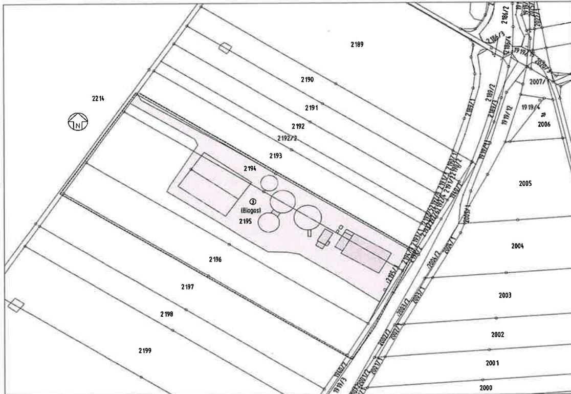
Das bestehende Sondergebiet soll nach Süd-Westen erweitert werden um in Zuordnung der bestehenden Biogasanlage, eine weitere Biogasanlage, ein Rinderstall als auch ein Betriebsleiterwohnhaus erstellen zu können.
